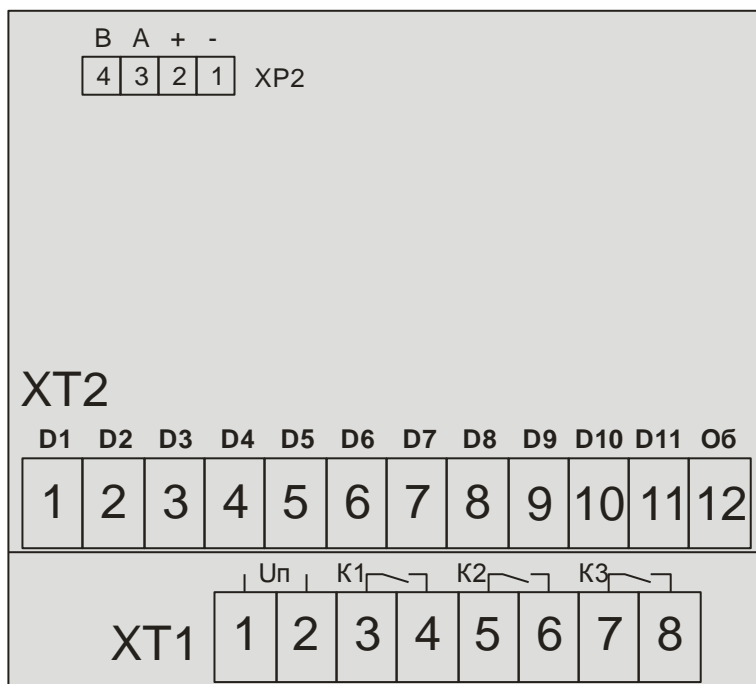
Рисунок 2 – Назначение выводов РУНО 3
