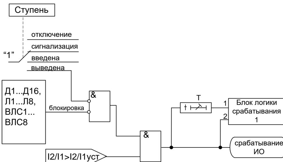
Рисунок 6.9 – Блок защиты от обрыва провода
