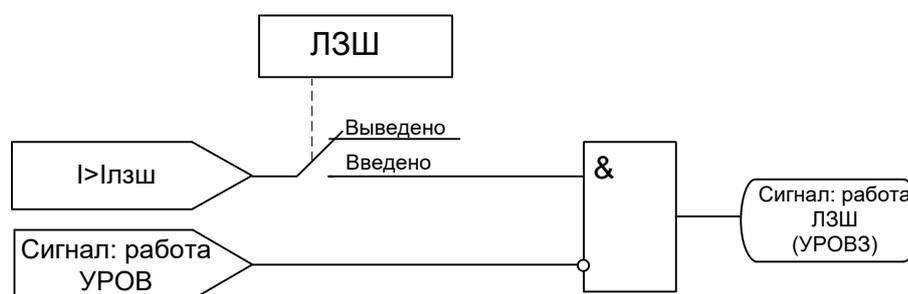
Рисунок 6.11 – Блок-схема логики УРОВ3 (схема 1)
