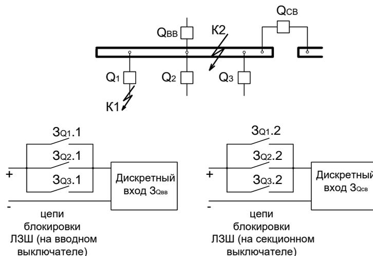
Рисунок 11.13 – Принцип действия логической защиты шин
