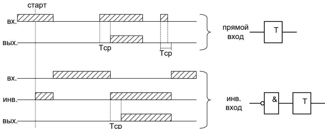
Рисунок 6.34 – Таймер на срабатывание (таймер 1)
