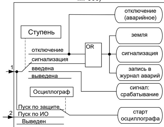
Рисунок 6.6 –Блок защиты от замыканий на землю
