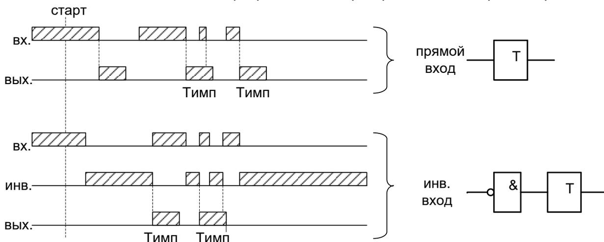
Рисунок 6.37 – Импульсный таймер по спаду типа 1 (таймер 4)
