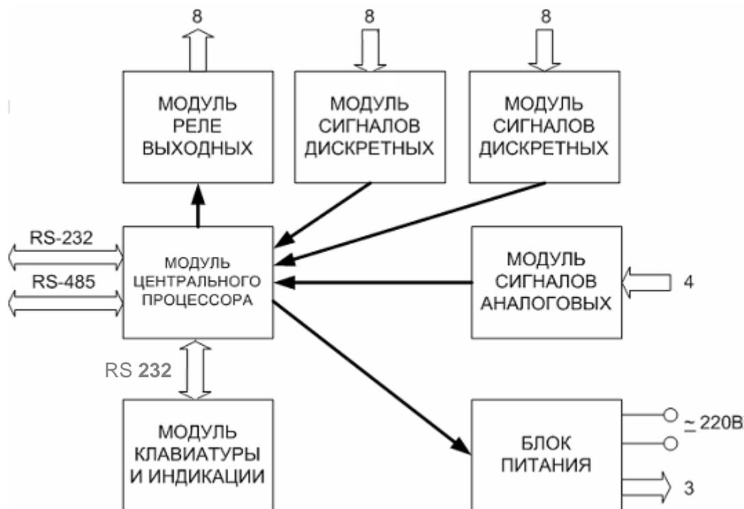
Рисунок 3.1 – Модульная структура
