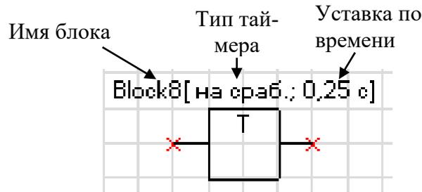
Рисунок 6.33 – Таймер
