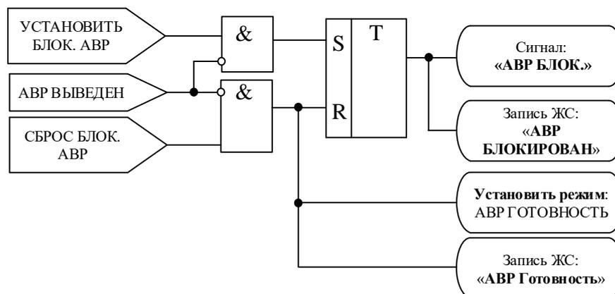
Рисунок 6.20 – Логика формирования сигнала «АВР БЛОК»
