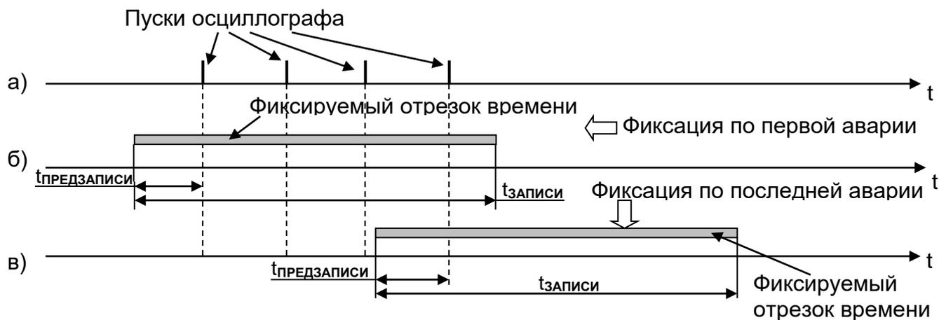
Рисунок 7.2 – Пояснения к значениям параметра «Фиксация»
