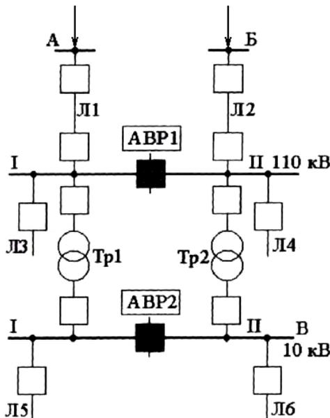
Рисунок 11.11 – Схема нормально разомкнутой распределительной сети
