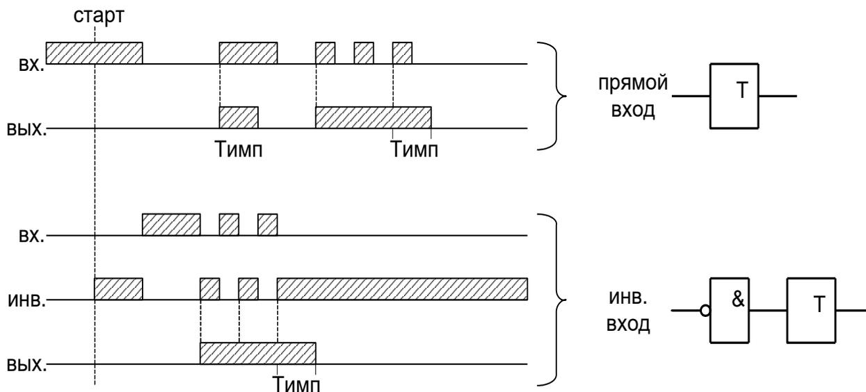
Рисунок 6.38 – Импульсный таймер по фронту типа 2 (таймер 5)
