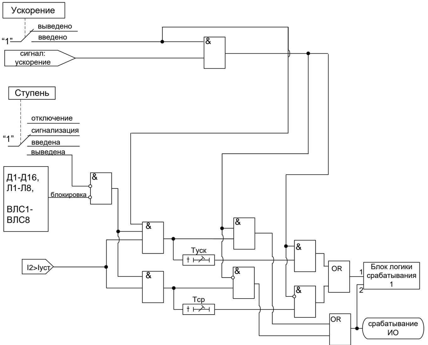
Рисунок 6.7 – Блок защиты от повышения тока обратной последовательности
