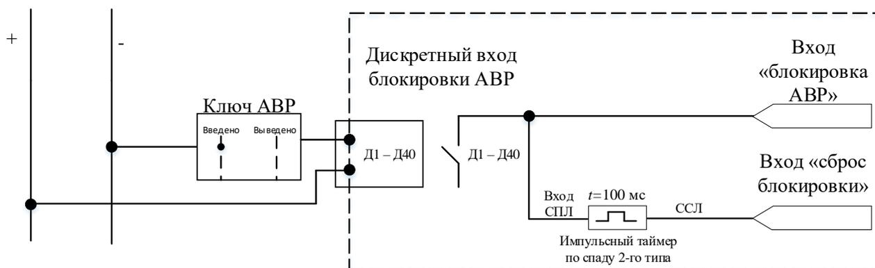
Рисунок 11.10 – Схема для оперативного ввода/вывода АВР из работы
