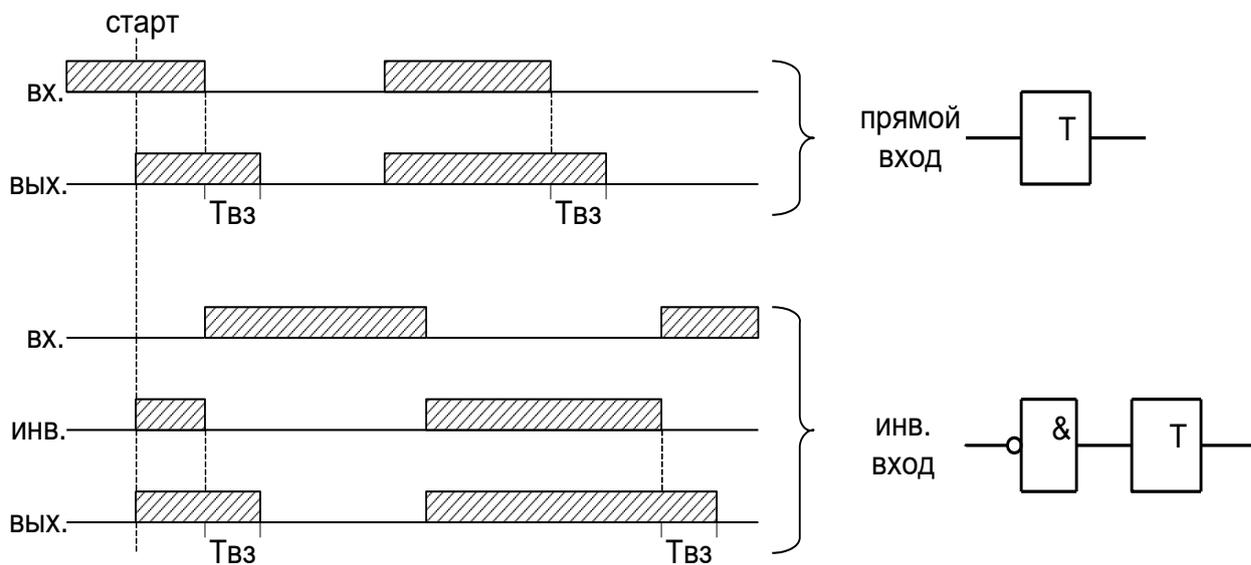
Рисунок 6.35 – Таймер на возврат (таймер 2)
