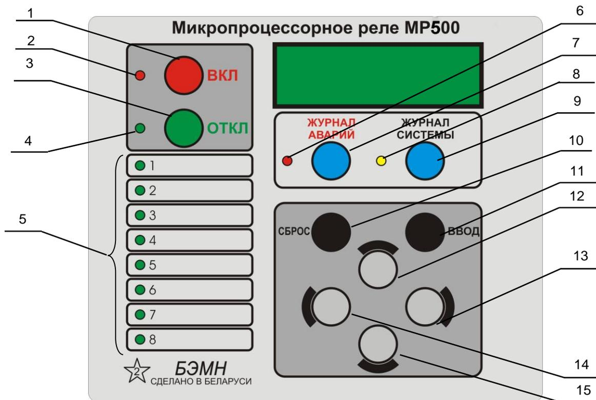
Рисунок 7.1 – Органы управления и индикации МР500
