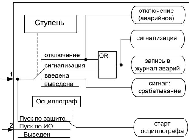
Рисунок 6.5 – Логическая схема защиты от повышения тока (блоки)
