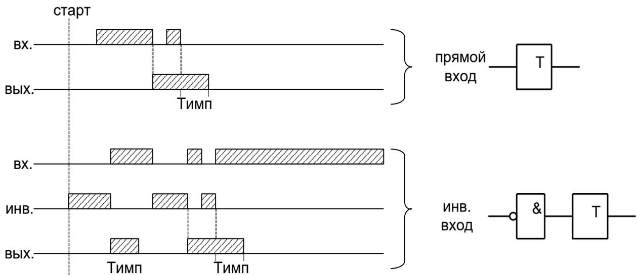
Рисунок 6.39 – Импульсный таймер по спаду типа 2 (таймер 6)
