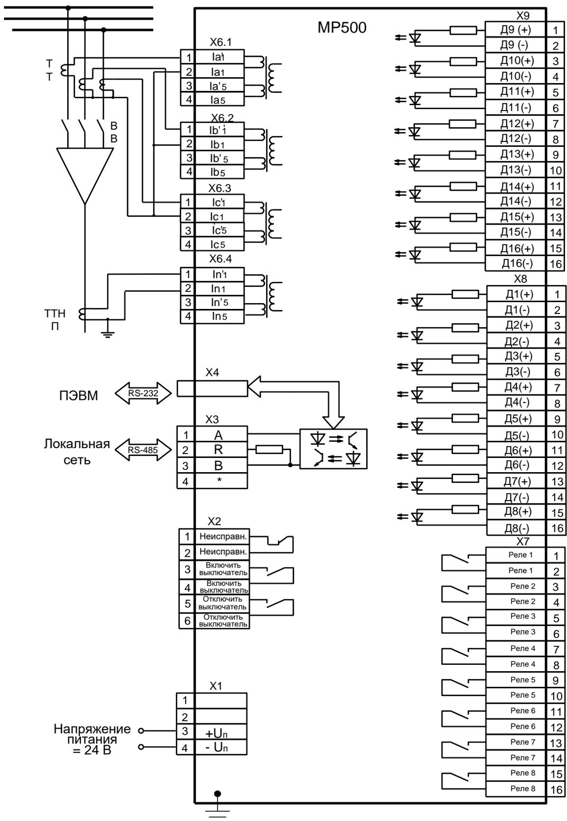
Схема подключения с 3-мя трансформаторами тока, номинальное напряжение питания =24 В
