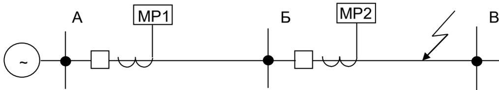
Рисунок 6.2 – Выбор зависимости характеристики смежных участков
