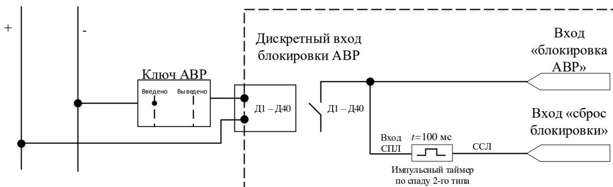
Рисунок 6.22 – Схема для оперативного ввода/вывода АВР из работы
