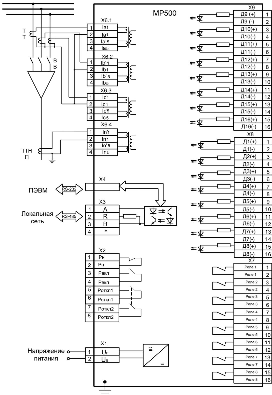
Схема подключения с 3-мя трансформаторами тока, номинальное напряжение питания ~230 В (=220 В)
