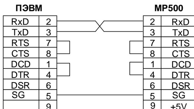
Рисунок 8.3 - Подключение к ПЭВМ с применением нуль-модемного кабеля
