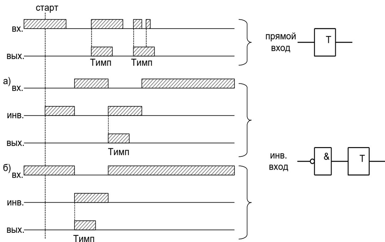
Рисунок 6.36 – Импульсный таймер по фронту типа 1 (таймер 3)
