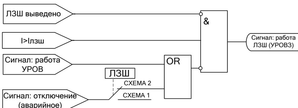
Рисунок 6.12 – Блок-схема логики УРОВ3 (схема 2)
