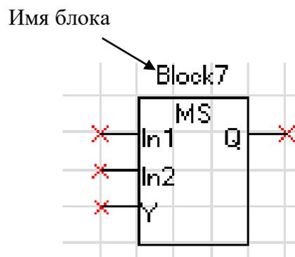
Рисунок 6.40 – Мультиплексор
