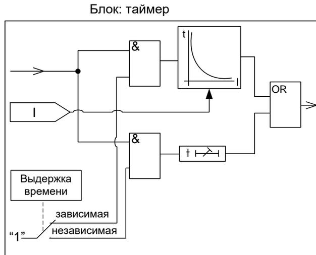
Блок-схема логики срабатывания 1
