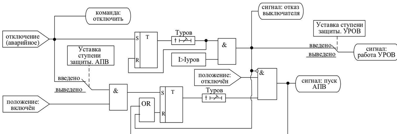
Рисунок 5.5 – Логика работы МР500 при аварийном отключении
