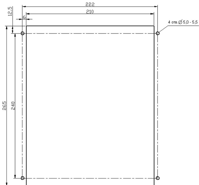
Рисунок А.2 – Размеры окна и монтажных отверстий под установку МР762
