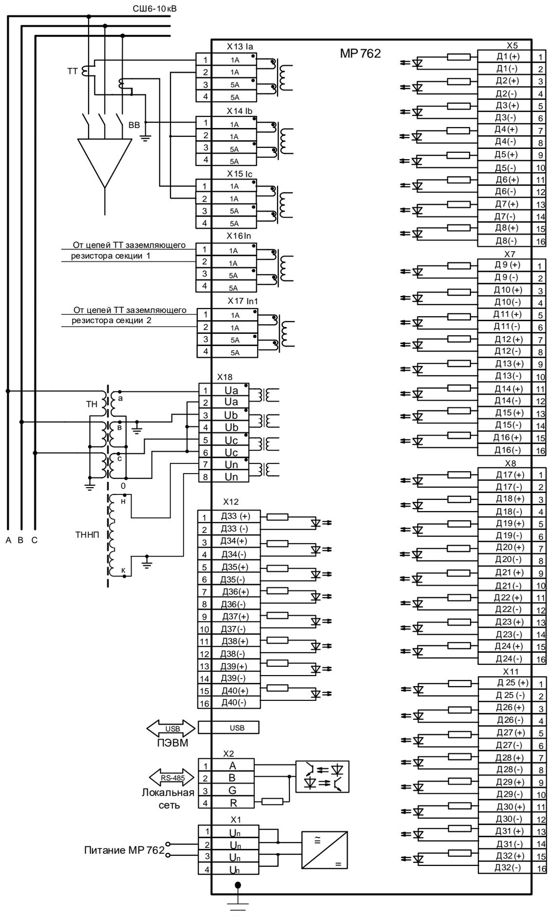
Рисунок А.5 – Схема подключения с двумя трансформаторами тока для МР762
