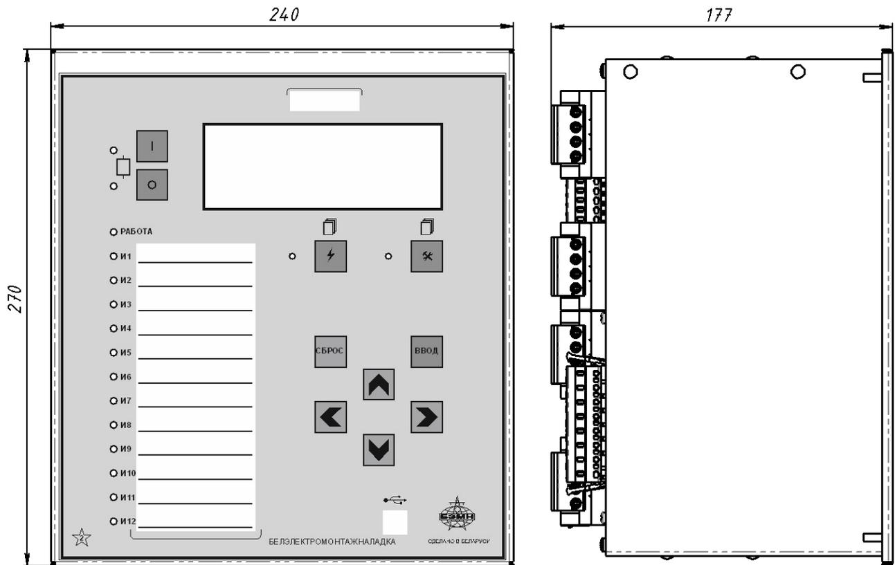
Рисунок А.1 – Габаритные размеры МР762
