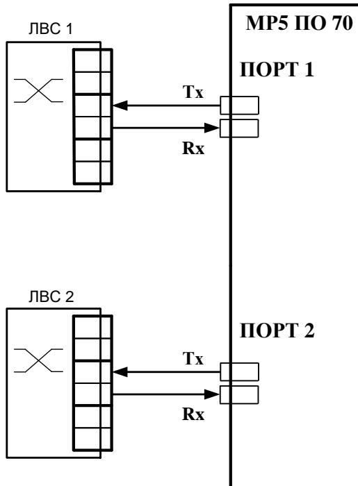
Рисунок 2.1 – Схема подключения с оптическим Ethernet интерфейсом MP5 ПО 70
