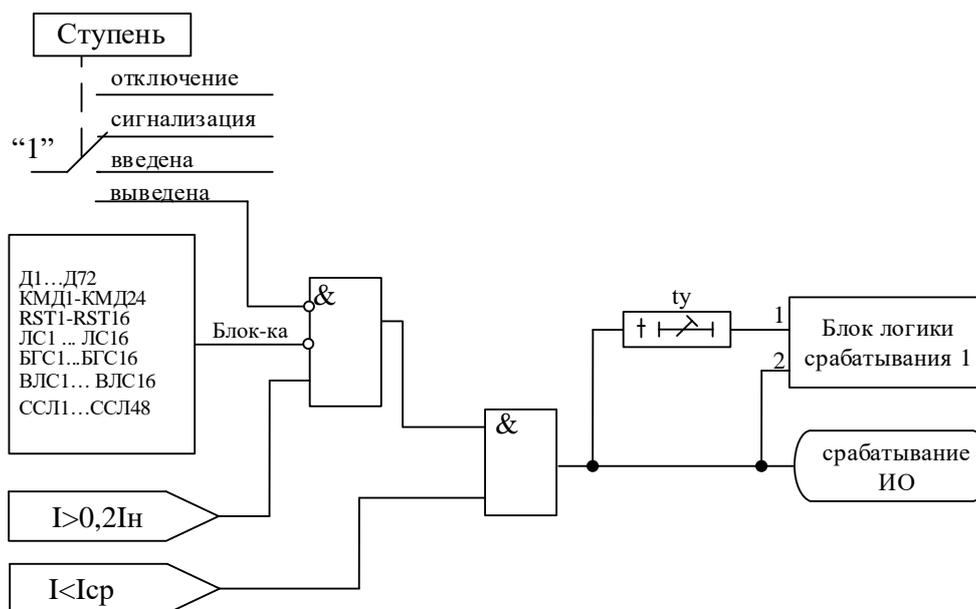
Рисунок 6.18 – Функциональная схема защиты по минимальному току
