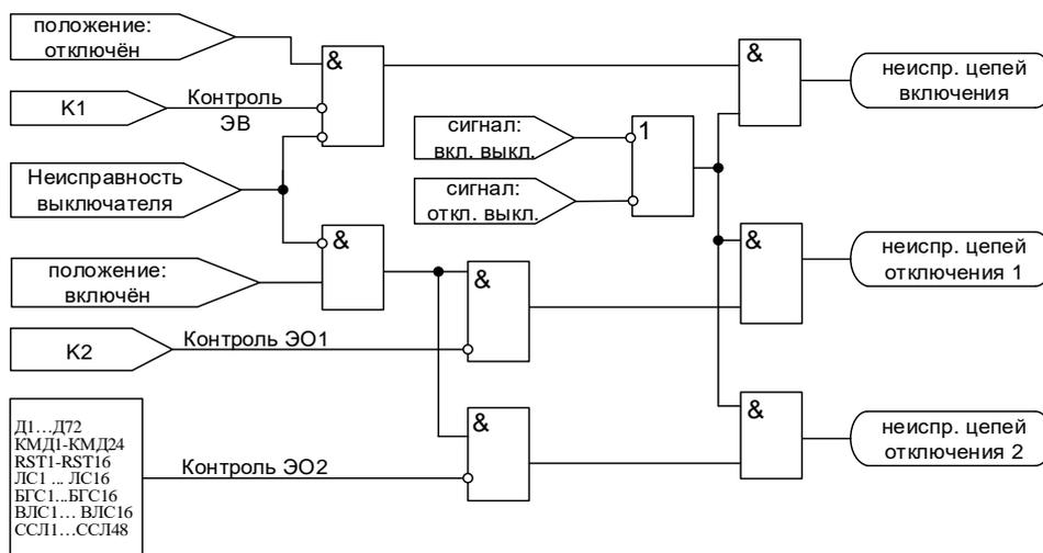
Рисунок 5.6 – Логическая схема контроля цепей управления
