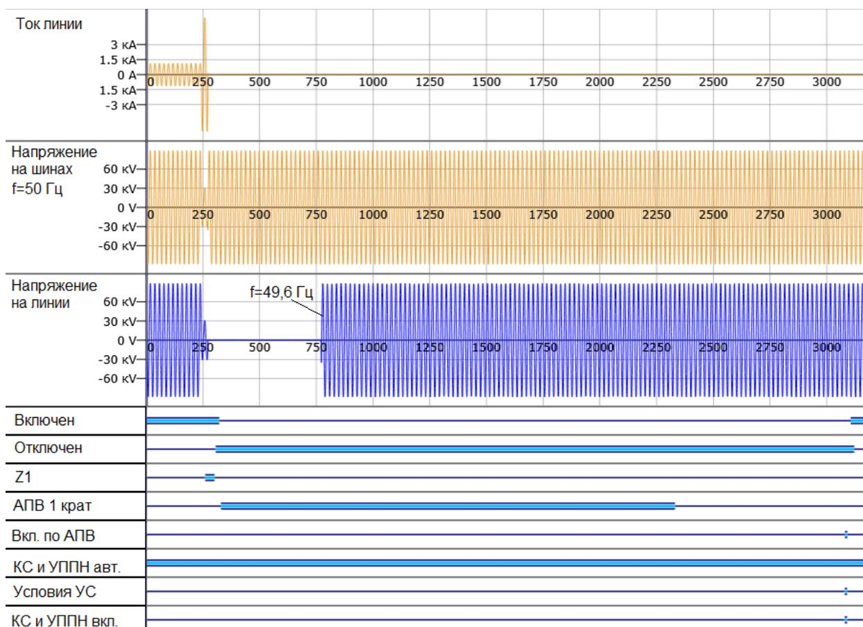
Рисунок 6.50 – Временная диаграмма работы АПВ с улавливанием синхронизма
