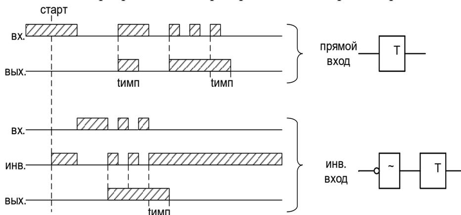
Рисунок 6.78 Импульсный таймер по фронту типа 2 (таймер 5)
