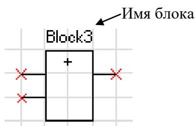
Рисунок 6.66– Логический элемент «сумма»
