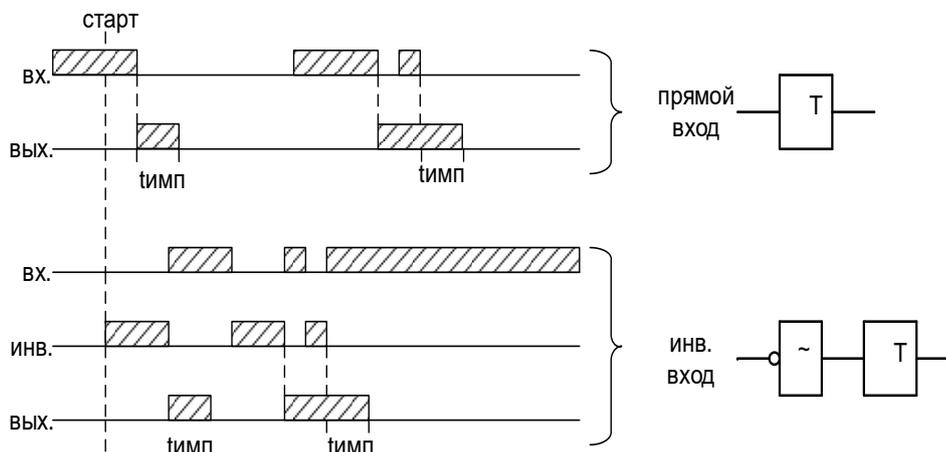
Рисунок 6.79– Импульсный таймер по спаду типа 2 (таймер 6)
