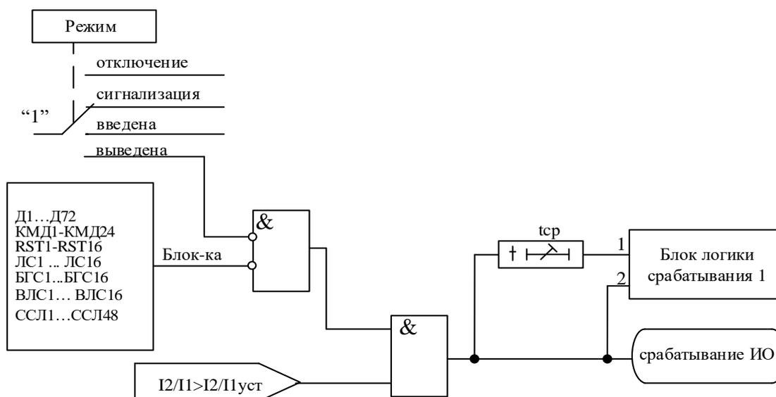
Рисунок 6.19 – Блок защиты от обрыва провода
