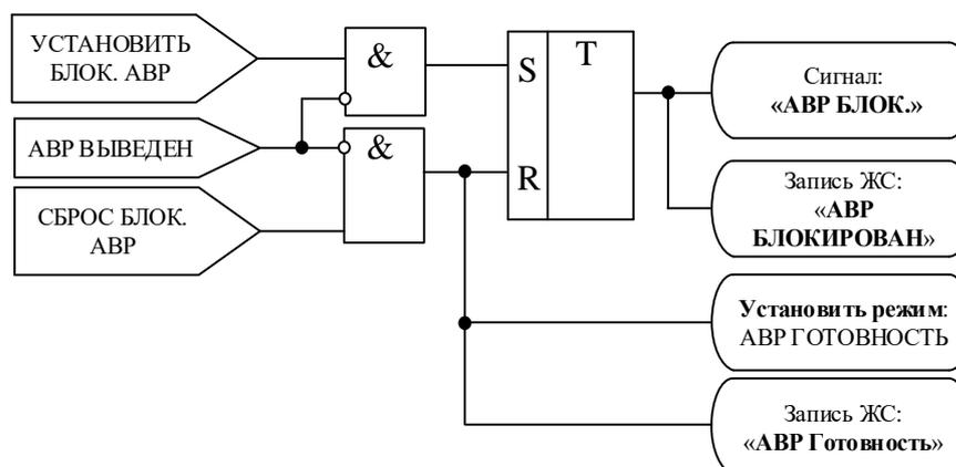
Рисунок 6.43 – Логика формирования сигнала «АВР БЛОК»
