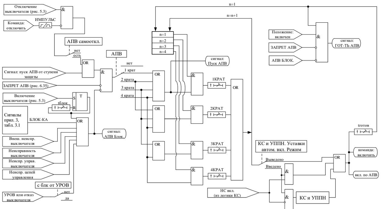
Рисунок 6.34б – Блок АПВ (с версии ПО 3.12)
