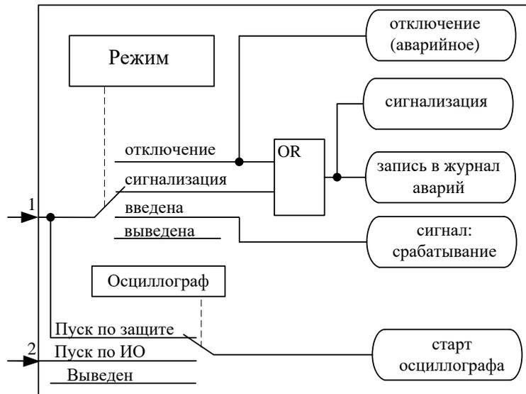
Рисунок 6.12 – Логическая схема направленной защиты от повышения тока (блоки)
