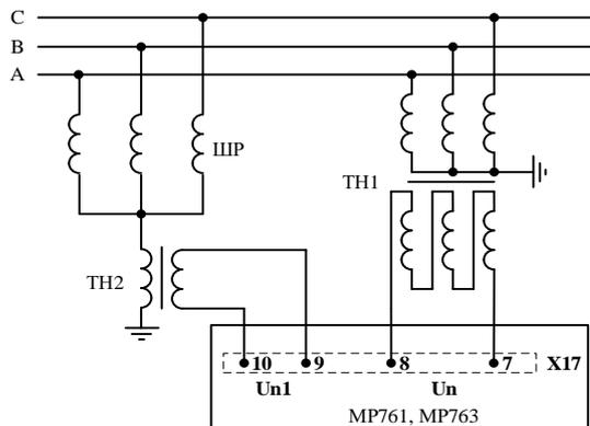
Рисунок 6.21 – Схема подключения для выполнения защиты ШП от витковых замыканий по повышению дифференциального напряжения
