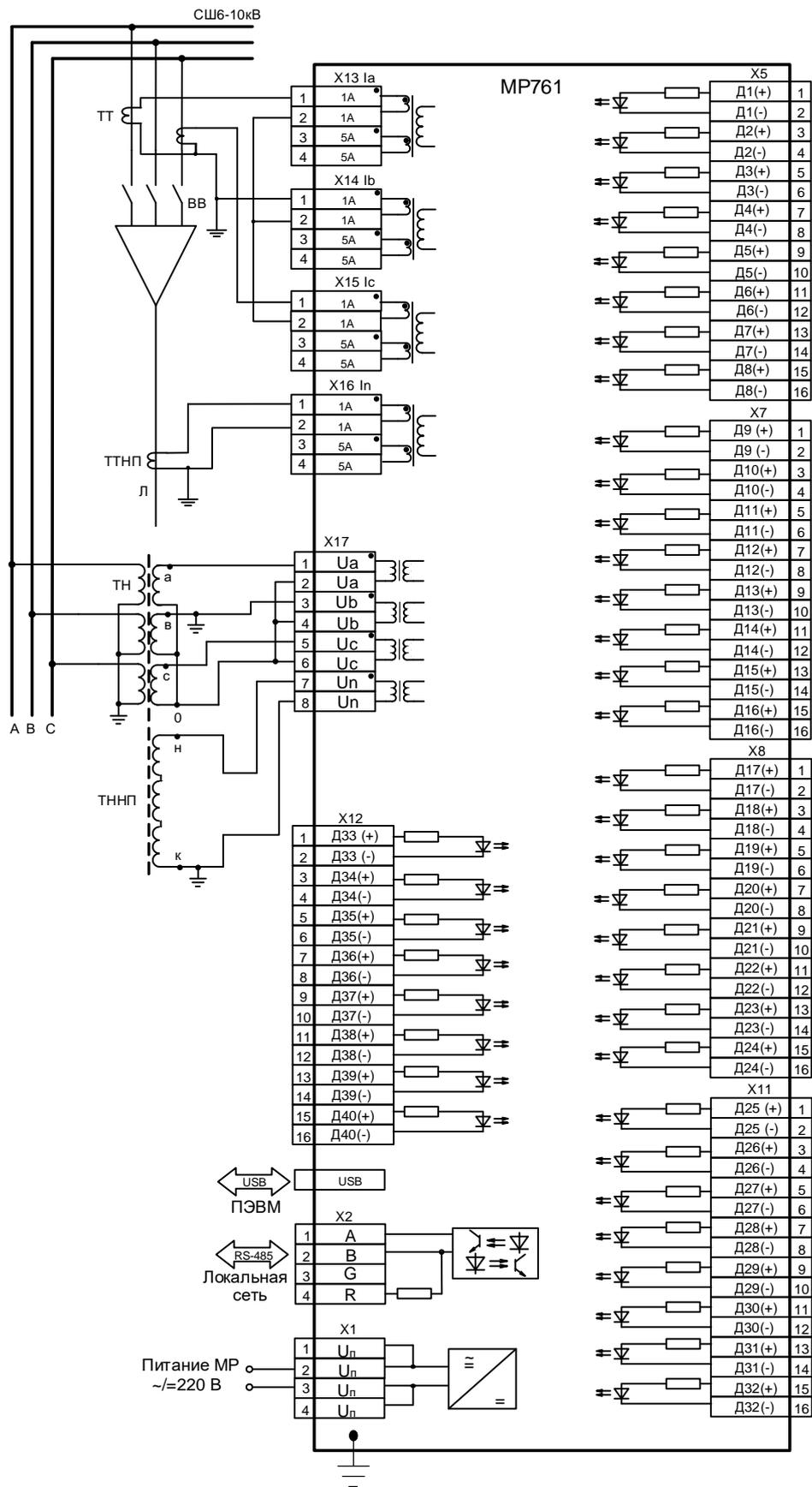
Схема подключения с двумя трансформаторами тока для МР761 (исполнение Т4, N4, D42, R35).
