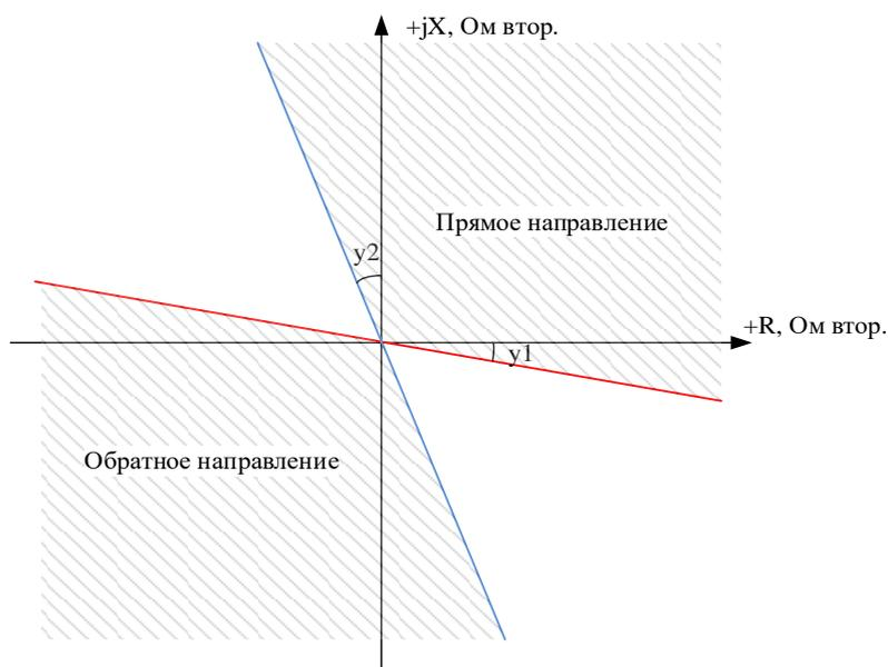
Рисунок 6.5 – Определение направления
