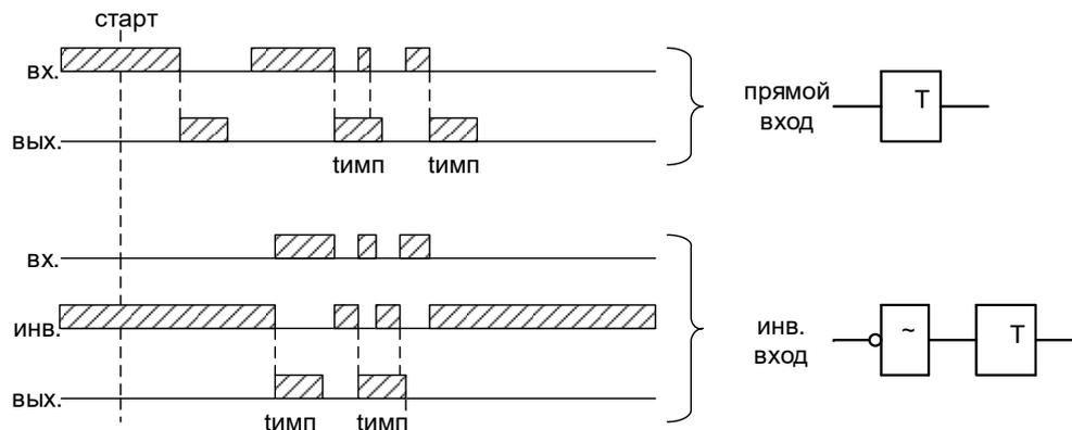
Рисунок 6.77– Импульсный таймер по спаду типа 1 (таймер 4)
