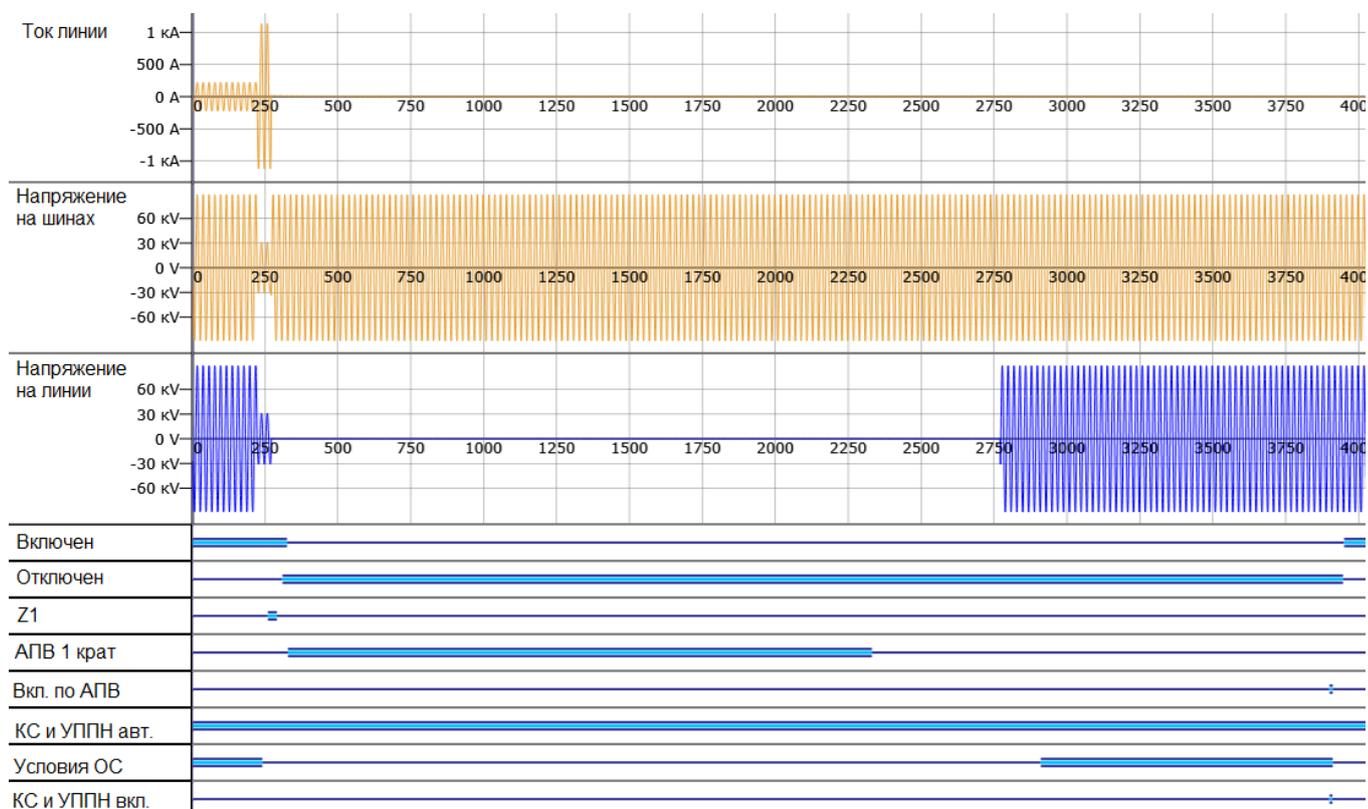
Рисунок 6.49 – Временная диаграмма работы АПВ с ожиданием синхронизма (условия ОС выполняются после завершения КРАТА АПВ)
