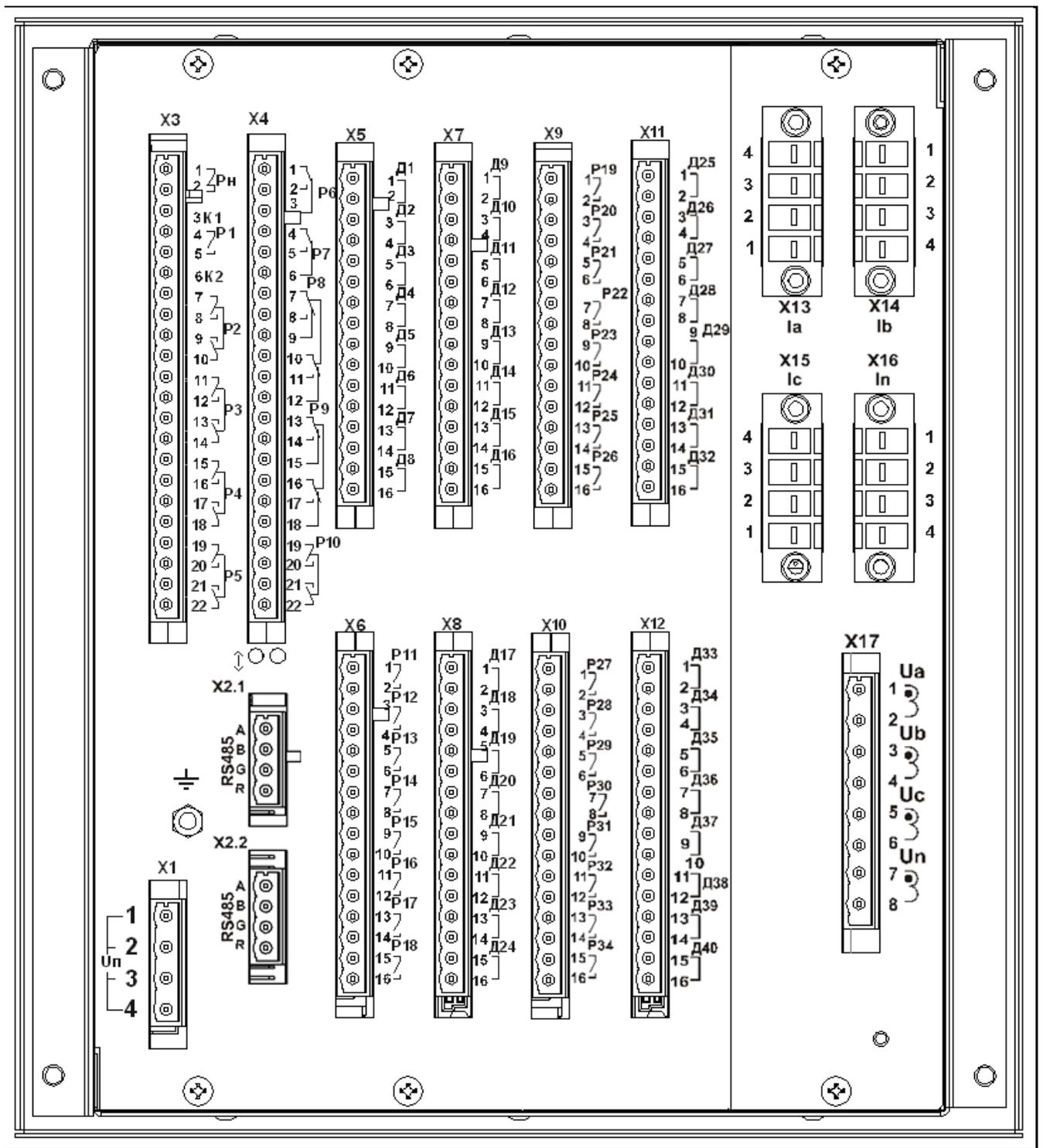
Вид задней панели MP761 с двумя портами RS485,
