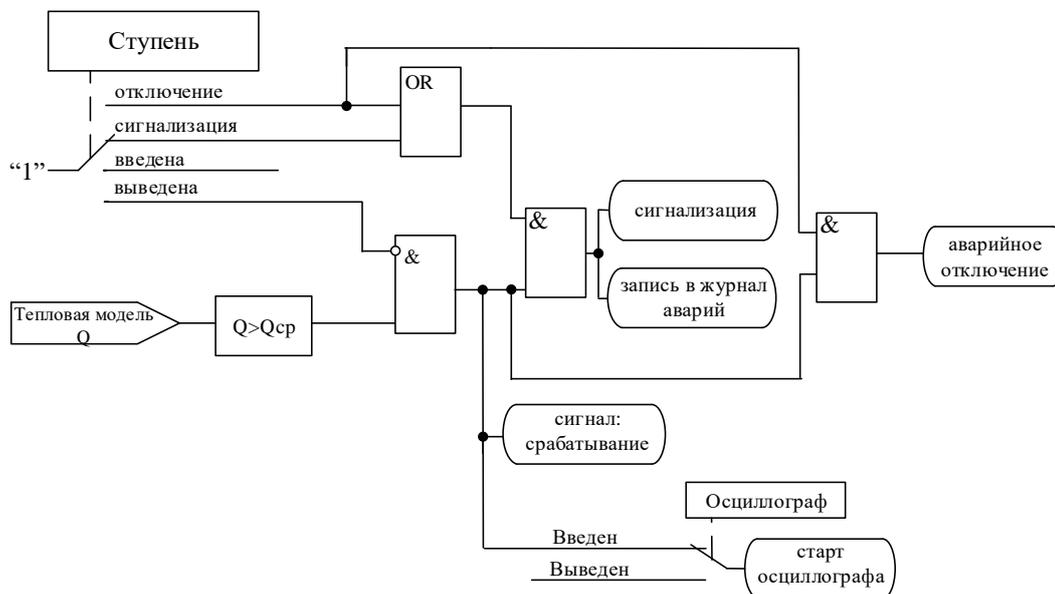
Рисунок 6.29 – Логическая схема ступени защиты от перегрева
