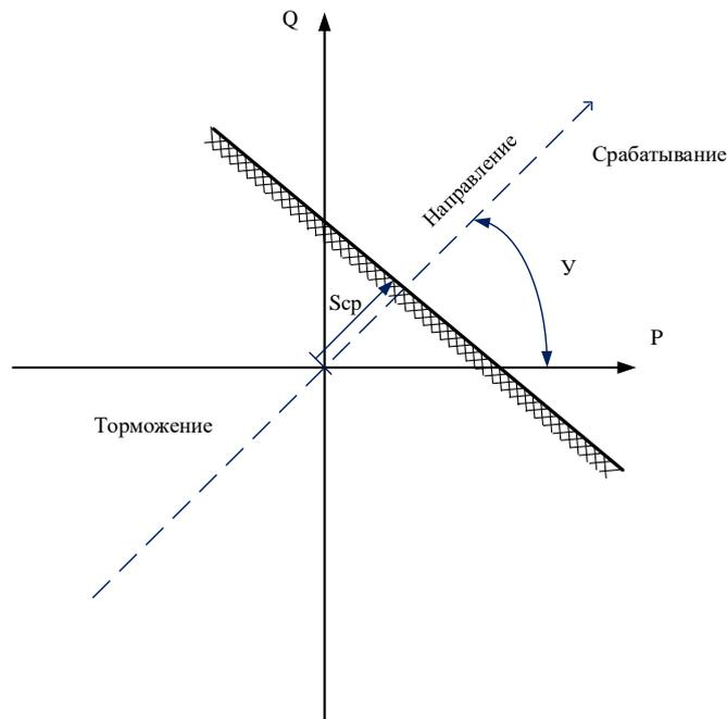
Рисунок 6.27 – Характеристика ступени защиты по мощности
