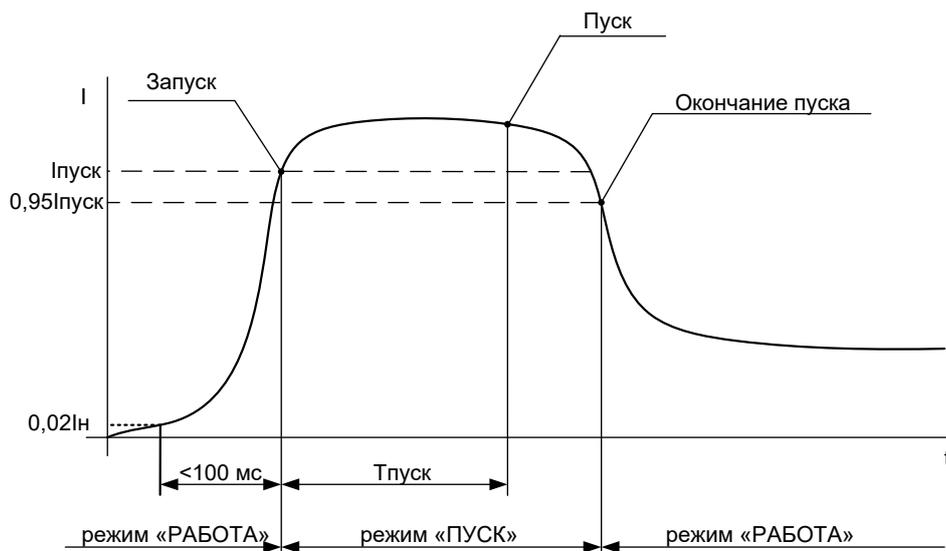
Рисунок 6.32 – Процесс пуска двигателя
