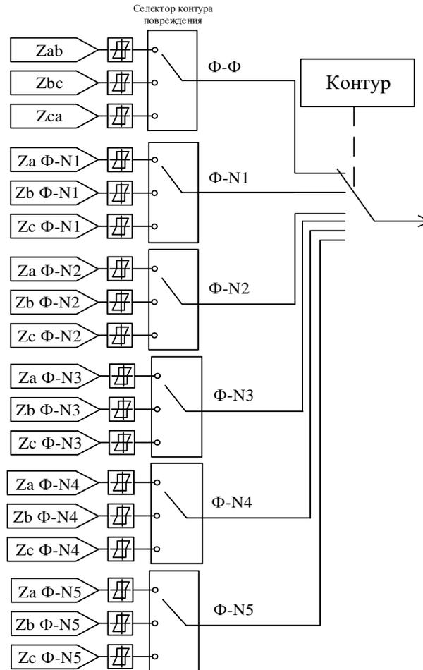
Рисунок 6.4 – Схема блока входной логики
