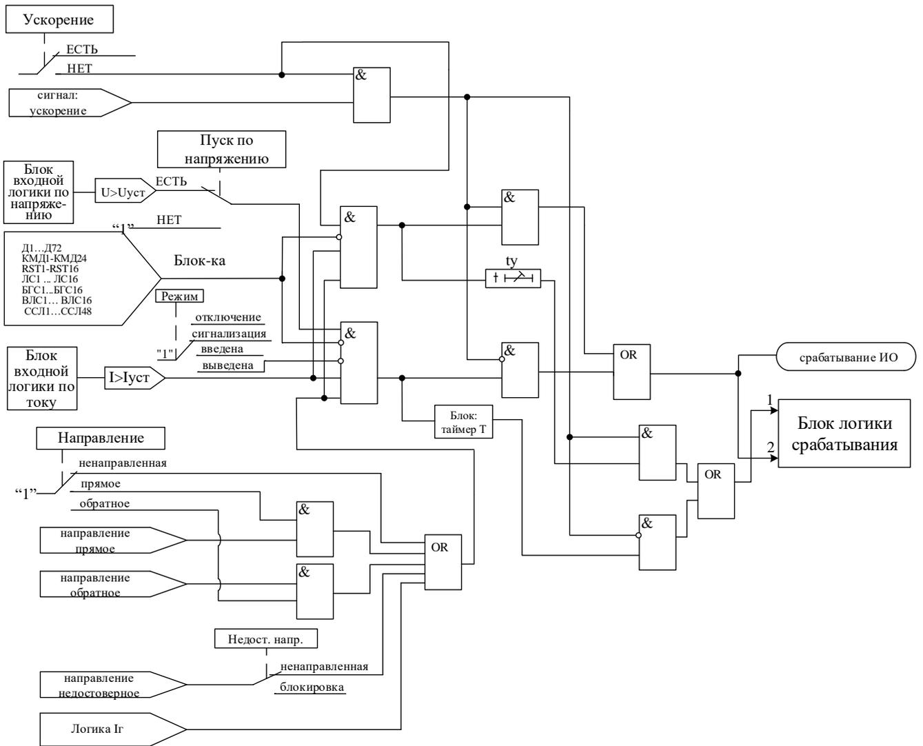
Рисунок 6.15 – Логическая схема ступеней токовой защиты I\*
