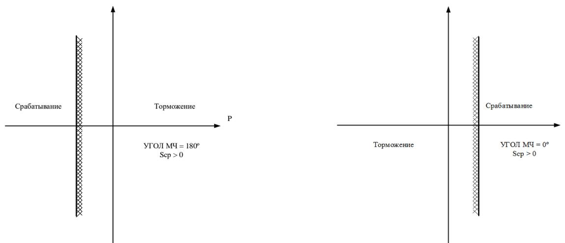
Рисунок 6.26 – Примеры характеристик срабатывания защит по мощности
