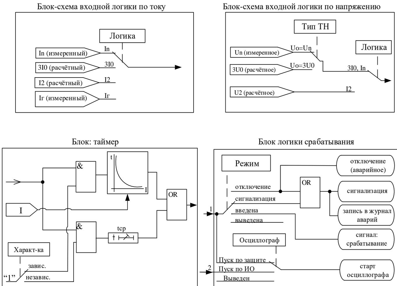
Рисунок 6.16 – Логическая схема ступеней токовой защиты I\* (блоки)
