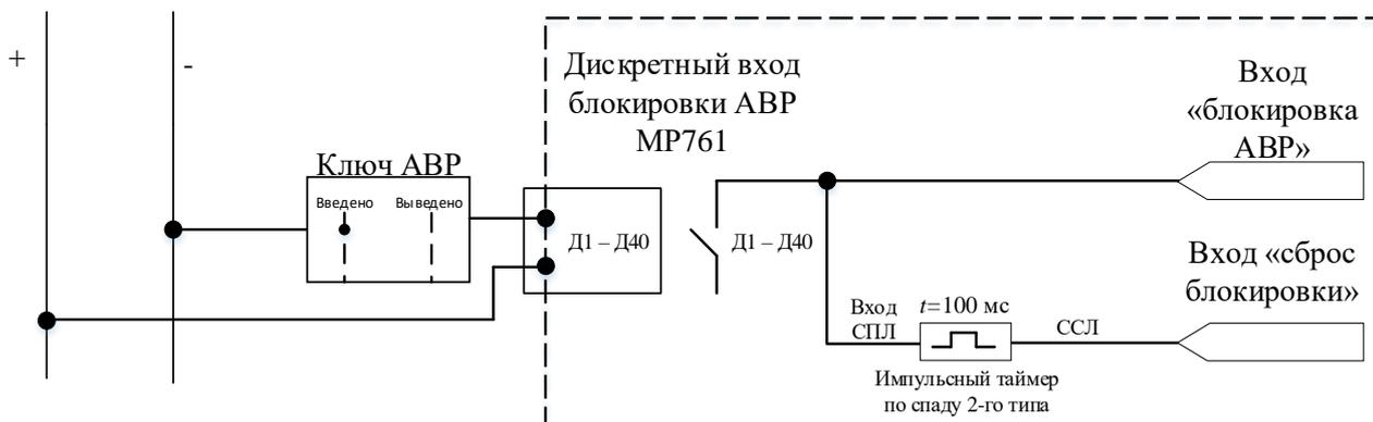
Рисунок 6.45 – Схема для оперативного ввода/вывода АВР из работы
