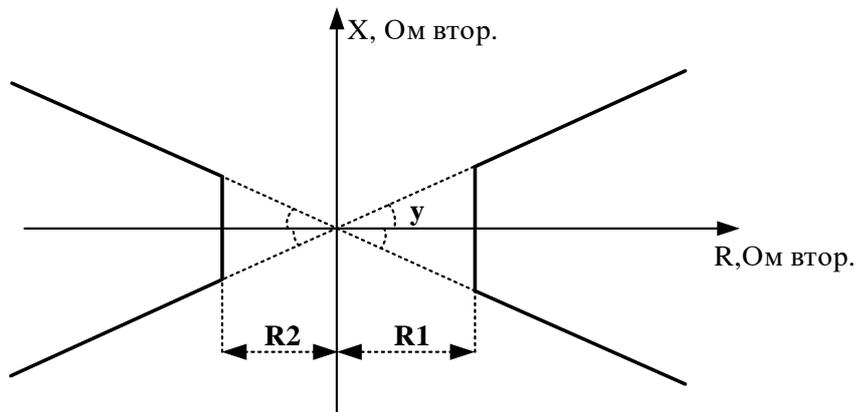
Рисунок 6.6 – Характеристика отстройки от нагрузочного режима
