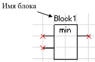
Рисунок 6.65– Логический элемент «MIN»
