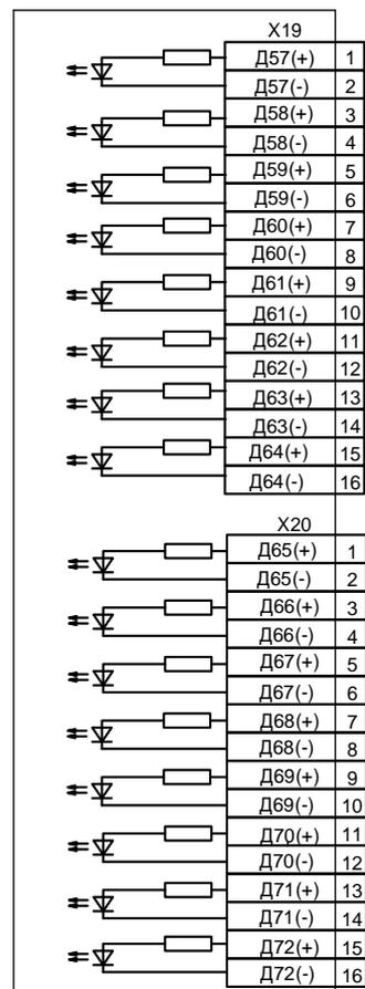
Схемы «А» – «К» подключения дискретных входов и релейных выходов, код аппаратного исполнения Т4, N4, D74, R67, корпус К3
