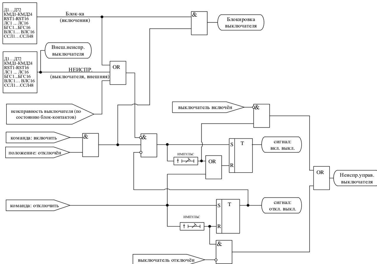
Рисунок 5.4 – Логика выдачи сигналов на включение/отключение выключателя
