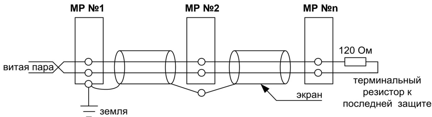
Рисунок 8.2 – Схема подключение кабеля
