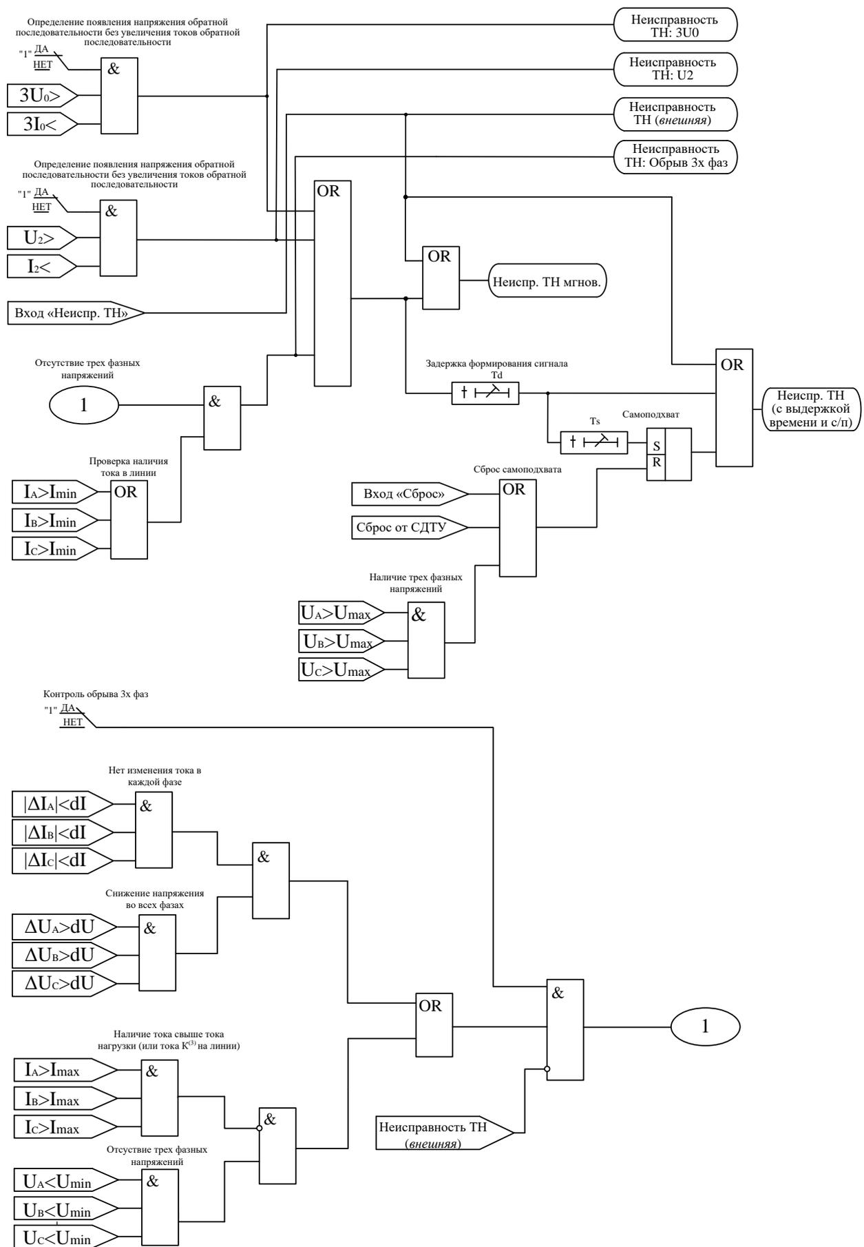
Рисунок 4.1 – Логика определения неисправности цепей напряжения
