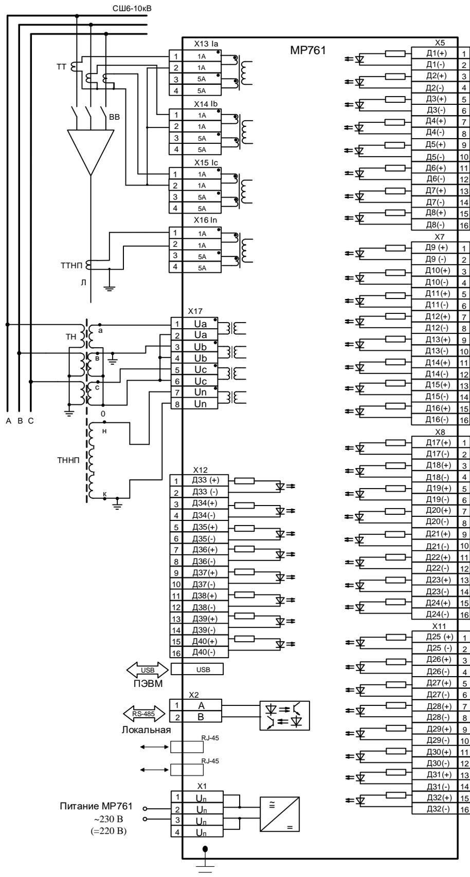
Схема подключения с тремя трансформаторами тока MP761 (исполнение Т4, N4, D42, R35), с двумя портами Ethernet типа RJ-45 (100BASE – Tx) и одним портом RS-485
