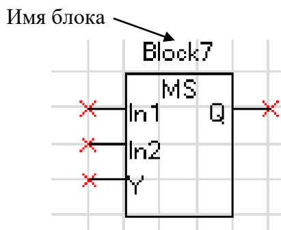
Рисунок 6.62 – Мультиплексор
