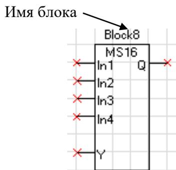
Рисунок 6.63 – Мультиплексор 16-разрядный
