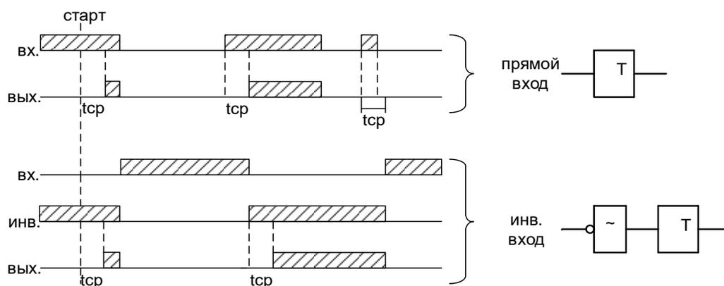
Рисунок 6.74 – Таймер на срабатывание (таймер 1)
