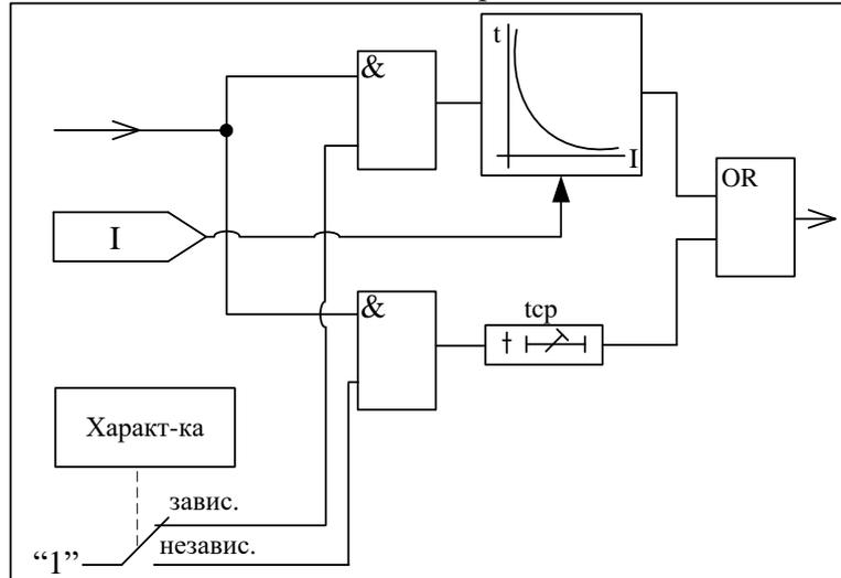
в) Блок-схема логики срабатывания 1 (общая для всех защит кроме токовых нулевой последовательности)
