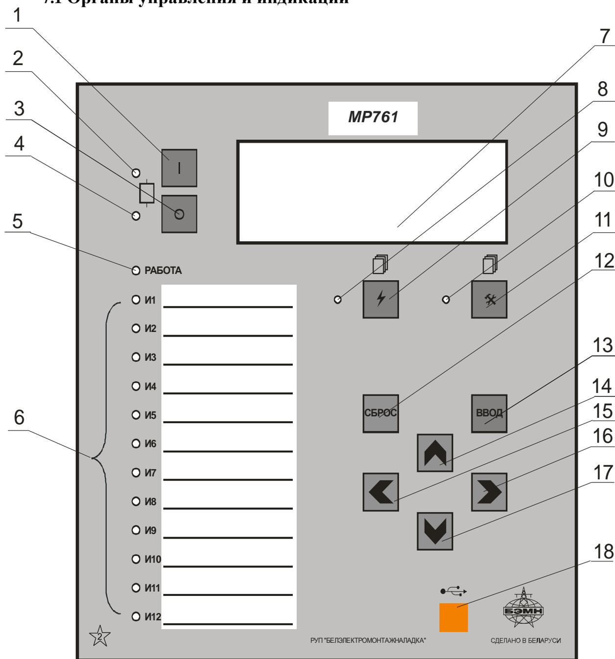
Рисунок 7.1 – Органы управления и индикации MP76X
