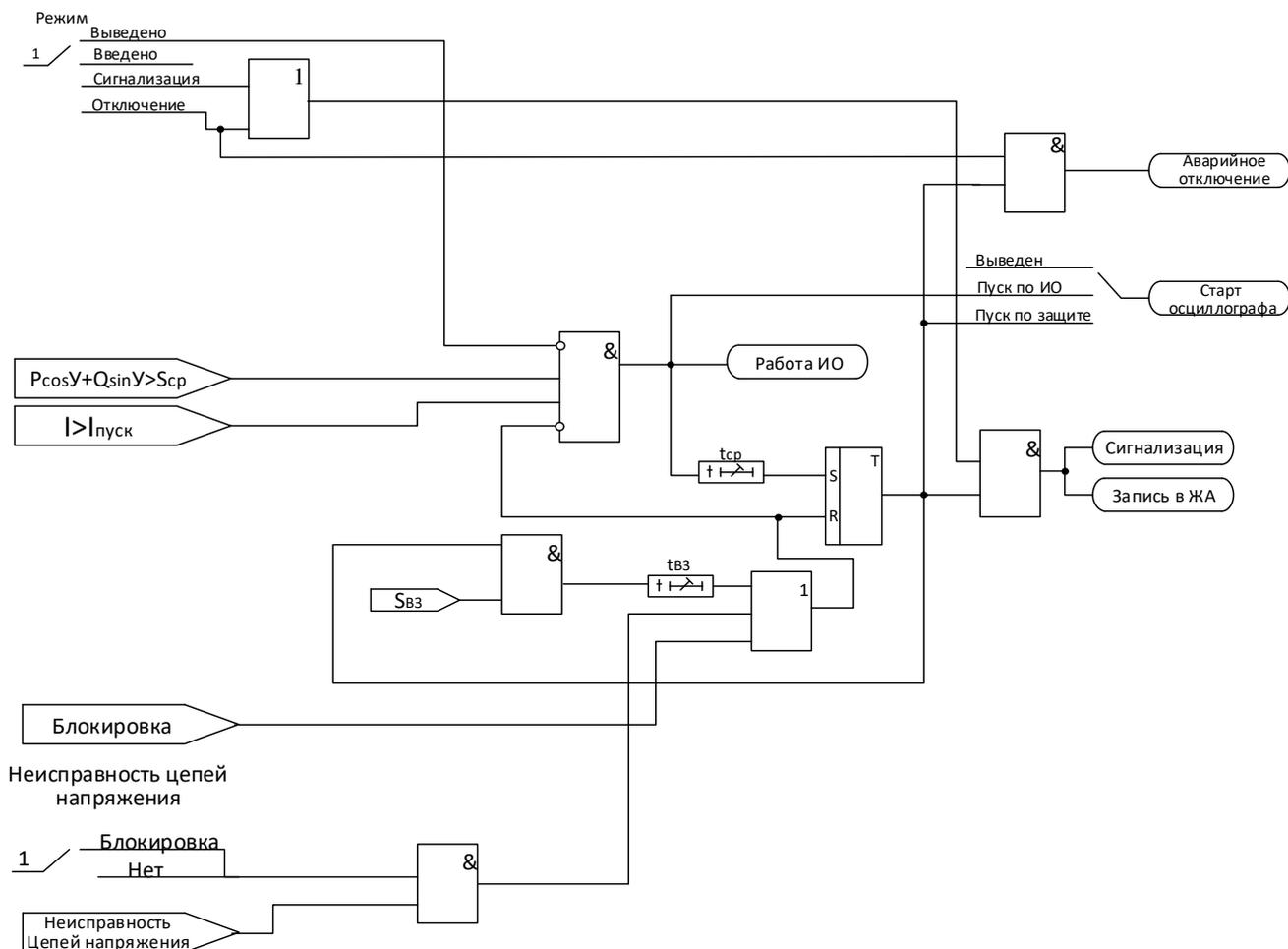
Рисунок 6.28 – Логическая схема защиты по мощности
