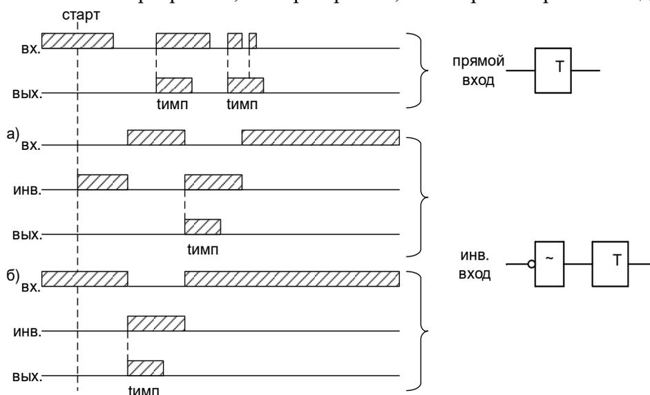
Рисунок 6.76 – Импульсный таймер по фронту типа 1 (таймер 3)
