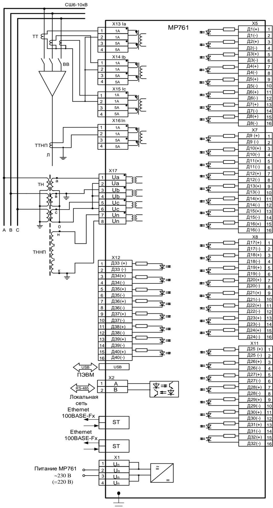
Схема подключения с тремя трансформаторами тока MP761 (исполнение Т4, N4, D42, R35), с двумя оптическими портами типа ST (100BASE – Fx) и одним портом RS-485
