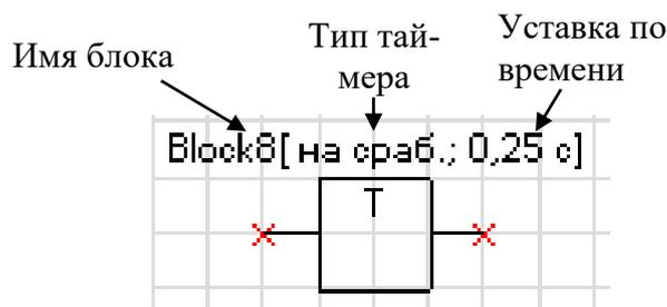
Рисунок 6.73 – Таймер
