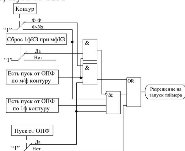
Рисунок 6.3 – Логическая схема ступеней дистанционной защиты
