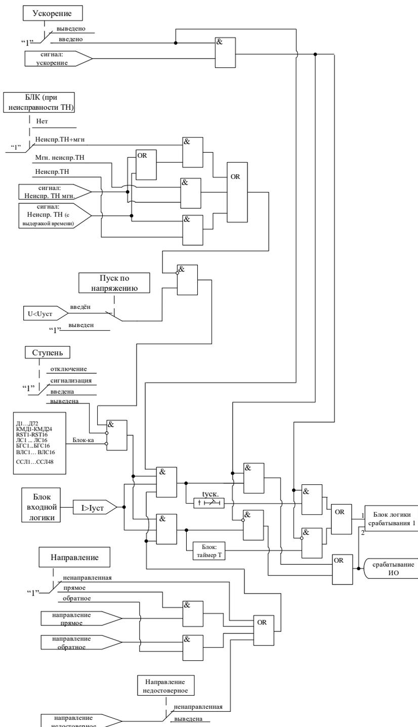
Рисунок 6.11 – Логическая схема направленной защиты от повышения тока (для ступеней I<sub>1></sub>, I<sub>2></sub>, I<sub>3></sub>, I<sub>4></sub>, I<sub>5></sub>, I<sub>6></sub>)
