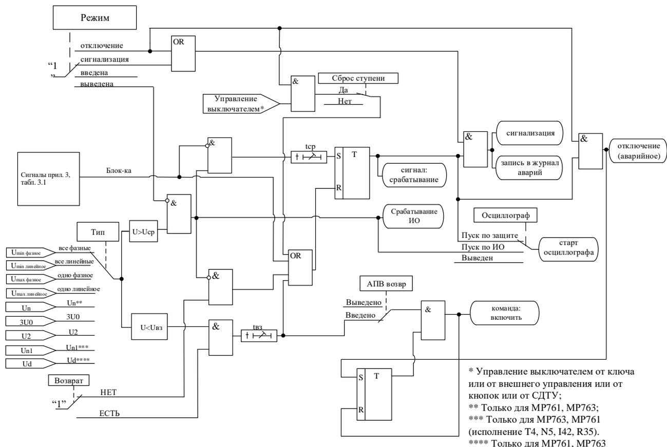
Рисунок 6.20 – Блок защиты от повышения напряжения
