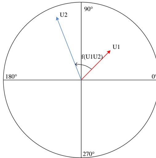
Рисунок 6.47 – Разность фаз между напряжениями сторон 1 и 2
