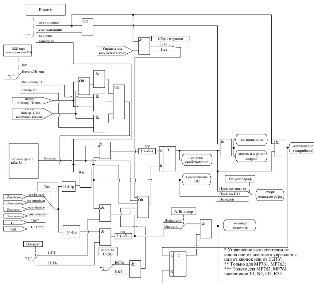
Рисунок 6.22 – Блок защиты от понижения напряжения
