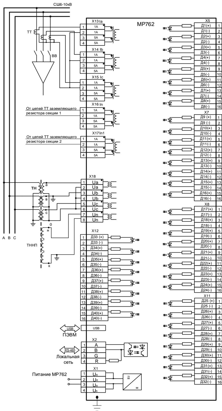
Схема подключения с тремя трансформаторами тока для MP762 (исполнение Т5, N4, D42, R35) – реализация защиты секционного выключателя в сети с заземляющими резисторами). На схеме приведено подключение аналоговых входов (измерительных каналов), дискретных входов, цепей электропитания и интерфейса (USB, RS-485)
