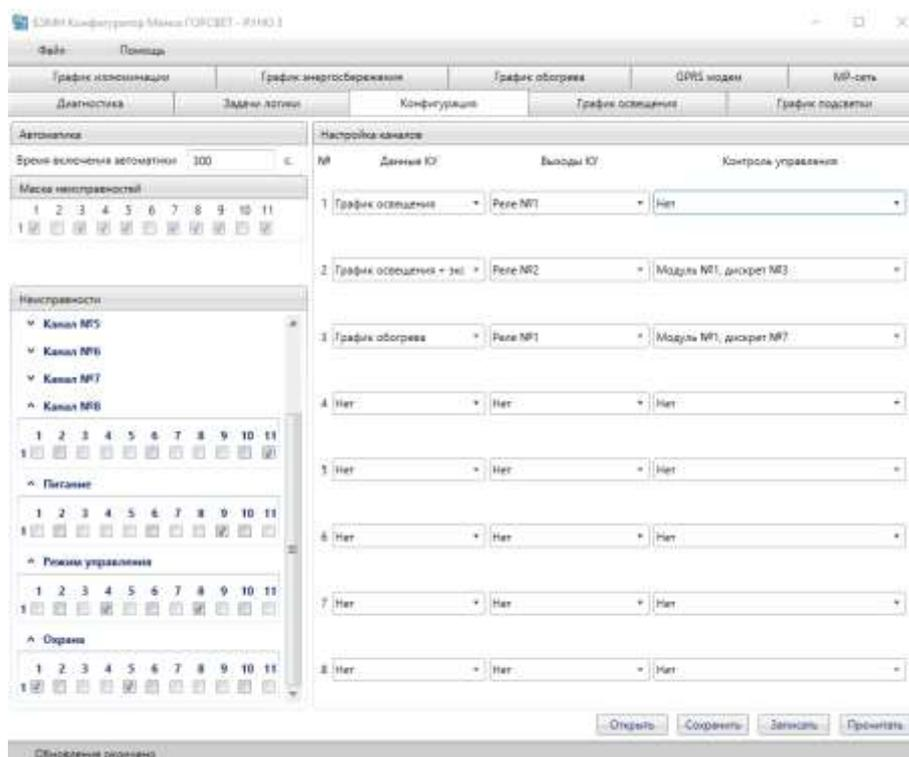
Рисунок 5.10 - Окно «Конфигурация» в БЭМН конфигураторе РУНО 3
