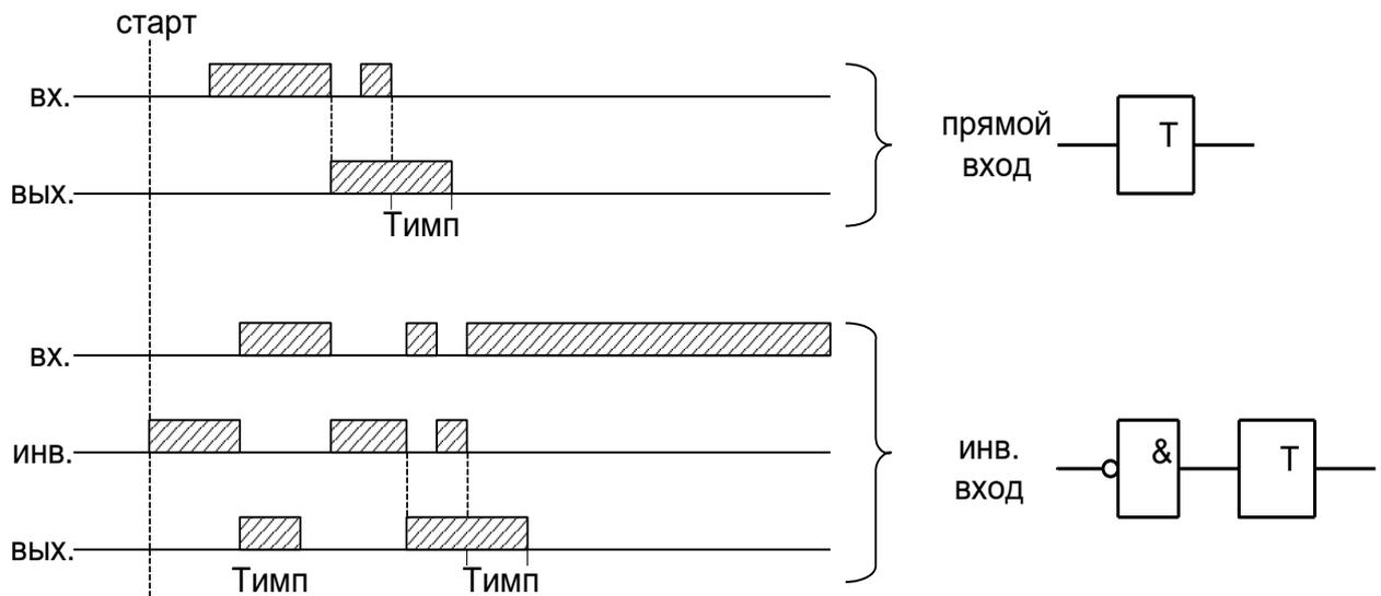
Рисунок 6.45 – Импульсный таймер по спаду типа 2 (таймер 6)
