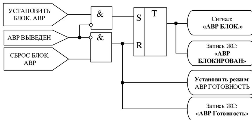
Рисунок 6.27 – Логика формирования сигнала «**АВР БЛОК**»
