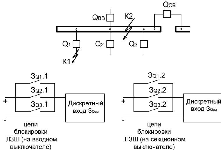
Рисунок 10.15 – Принцип действия логической защиты шин
