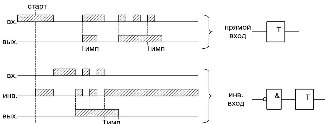
Рисунок 6.44 – Импульсный таймер по фронту типа 2 (таймер 5)
