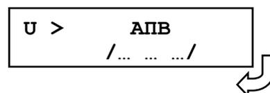
Разрешение на автоматическое повторное включение после срабатывания защиты: "ВВЕДЕНО", "ВЫВЕДЕНО".. **ВНИМАНИЕ!** При разрешенном АПВ и значении параметра АПВ ВЗ "ВВЕДЕНО" для ступени будет введено только АПВ по возврату. При разрешённом АПВ и значении параметра АПВ ВЗ "ВЫВЕДЕНО" для ступени будет введено только «обычное» АПВ, настраиваемое в меню АВТОМАТИКА.
