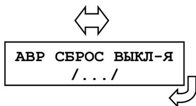
Сброс блокировки АВР, возврат схемы АВР в начальный шаг по включению/отключению выключателя.
