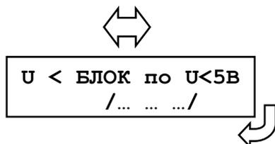
Ввод блокировки ступеней защиты U<; U<< при недостоверном определении напряжения (см. раздел 4):
