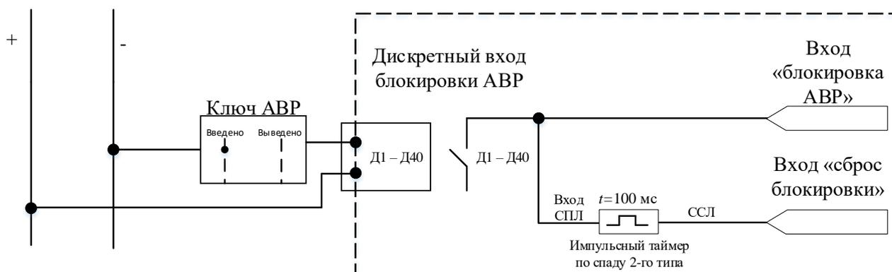
Рисунок 6.29 – Схема для оперативного ввода/вывода АВР из работы
