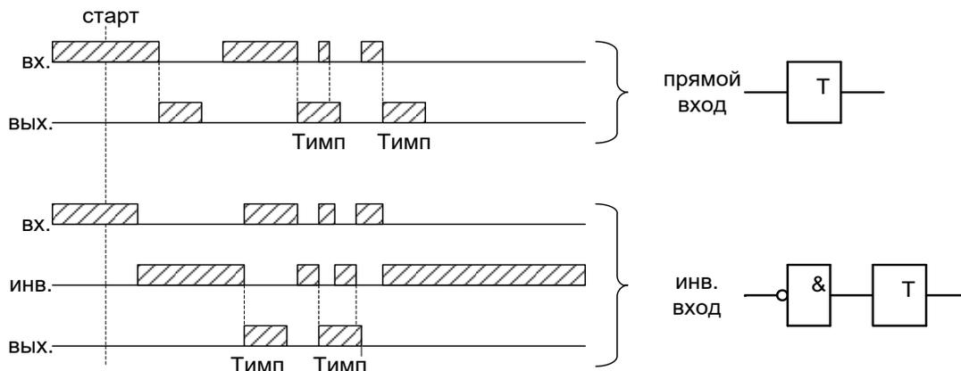
Рисунок 6.43 – Импульсный таймер по спаду типа 1 (таймер 4)
