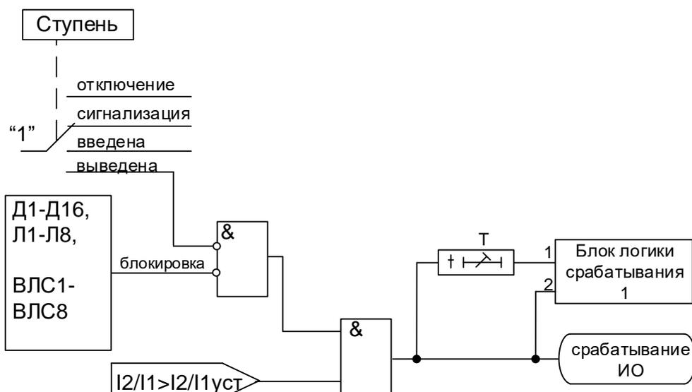
Рисунок 6.11 – Блок защиты от обрыва провода
