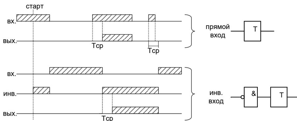
Рисунок 6.40 – Таймер на срабатывание (таймер 1)
