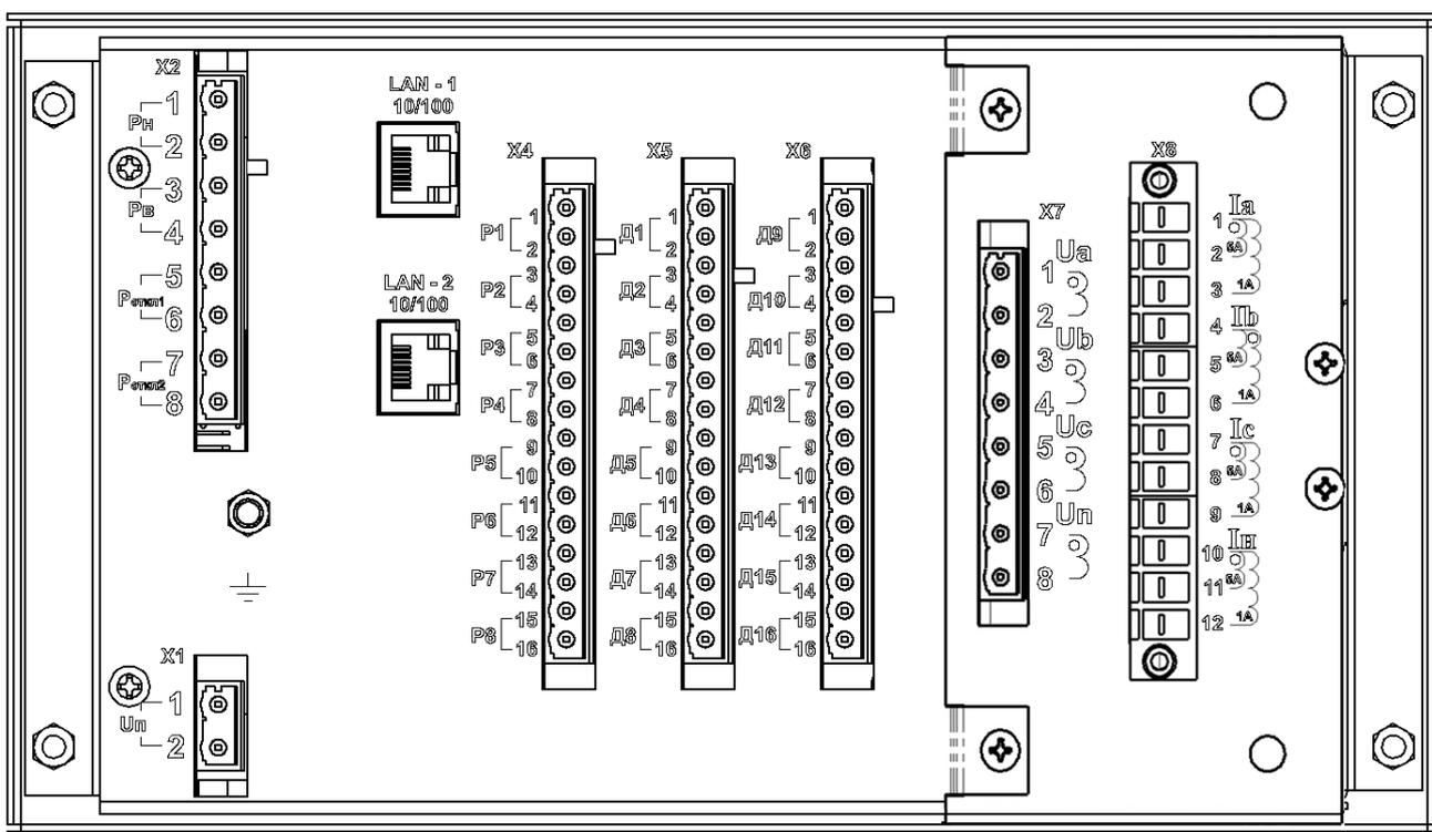
Рисунок Б.1 – Вид задней панели терминала защиты энергооборудования МР5, ПО 70
