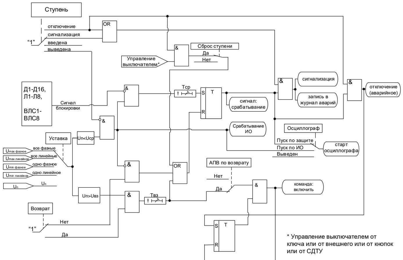
Рисунок 6.13 – Блок защиты от понижения напряжения
