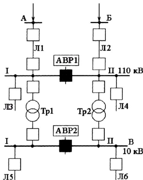
Рисунок 10.13 – Схема нормально разомкнутой распределительной сети
