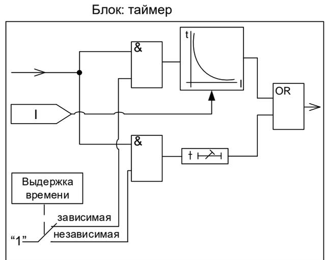
Блок-схема логики срабатывания 1
