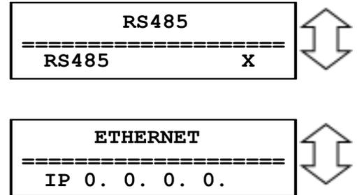
«Адрес» - Назначение номера устройства в сети.
