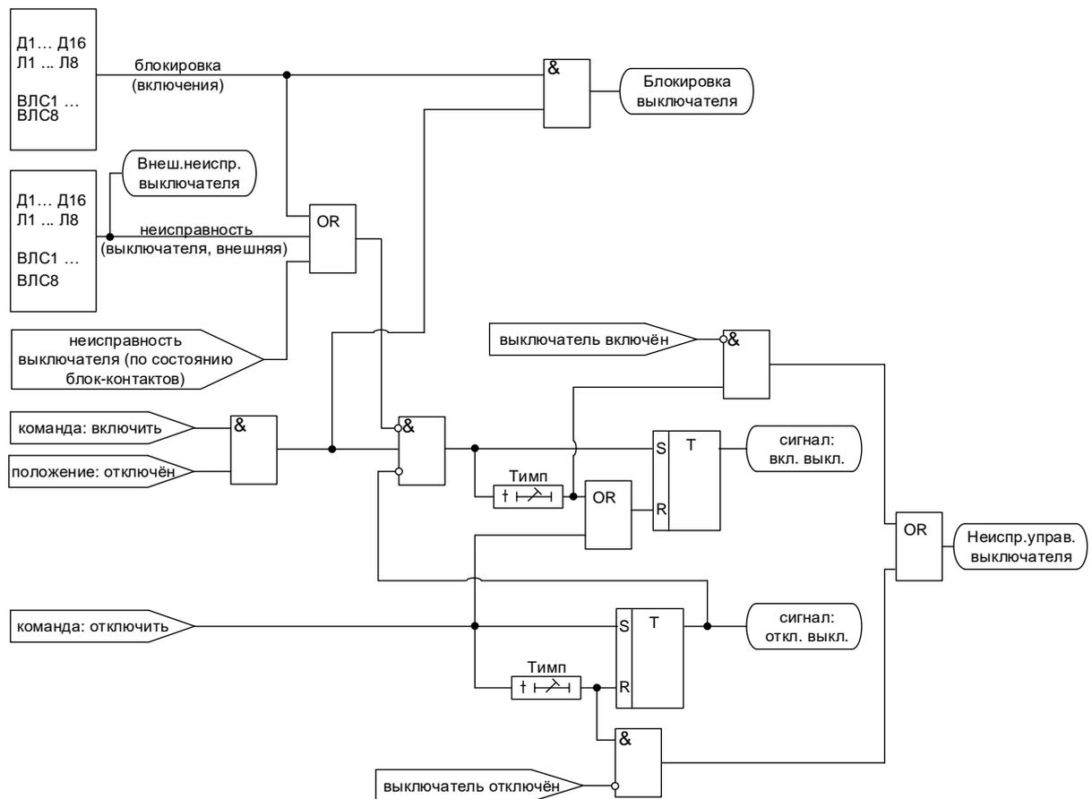
Рисунок 5.4 – Логика выдачи сигналов на включение/отключение выключателя
