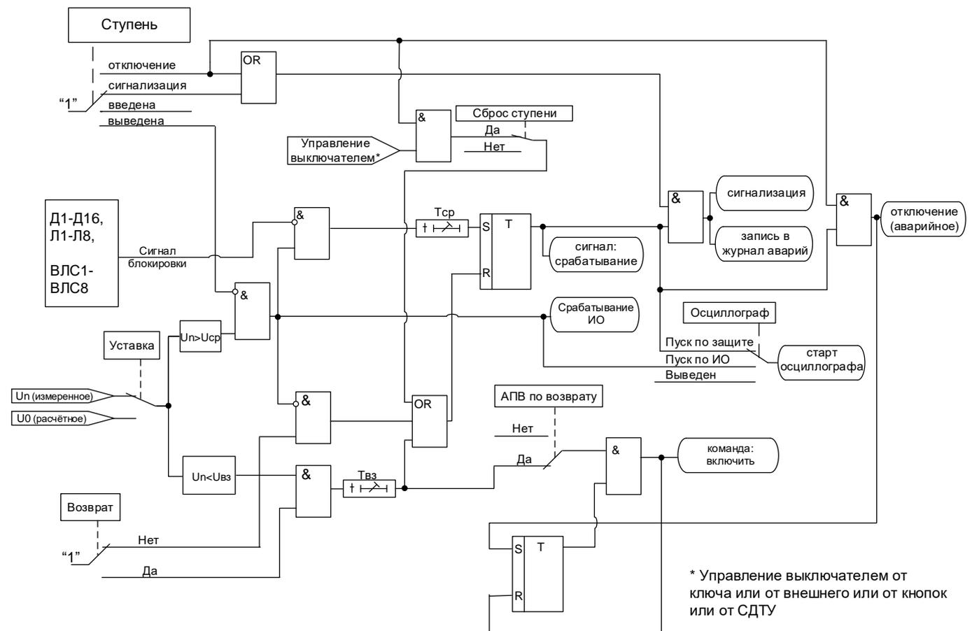
Рисунок 6.14 – Блок защиты от повышения напряжения нулевой последовательности
