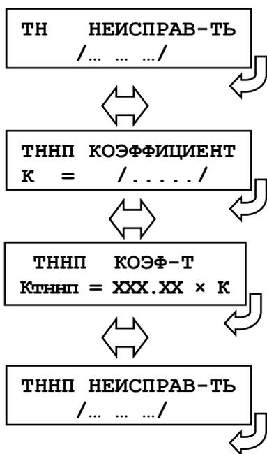
Конфигурирование внешнего сигнала неисправности фазного трансформатора напряжения. Список сигналов в Приложении Г, таблица Г.2.
